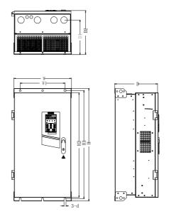
(d) Overall Dimensions of 90 kW - 400 kW Inverters
